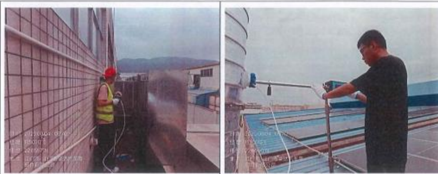
DA004 处理前废气采样
