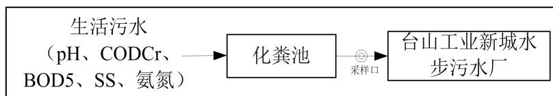
图 3-7 生活污水处理流程示意图
