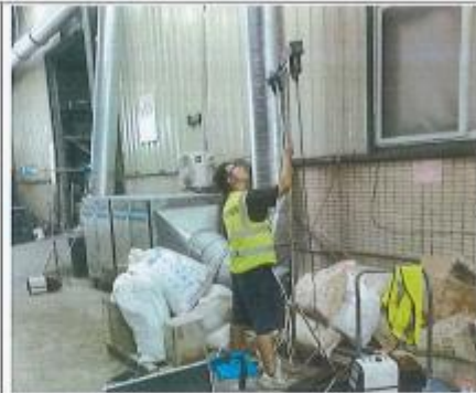
DA002 处理后废气采样
