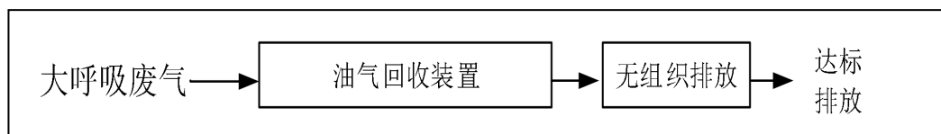
图 3-3 大呼吸废气处理流程示意图
