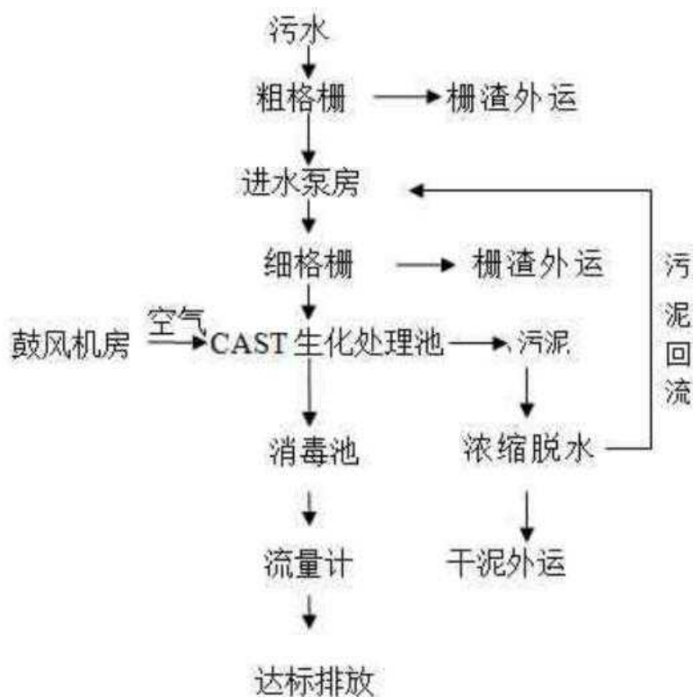
图 6.2.2-1 苍城镇污水处理厂工艺流程图
